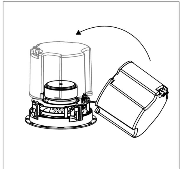
3. バックボックスを付属のネジでスピーカーに固定する。
